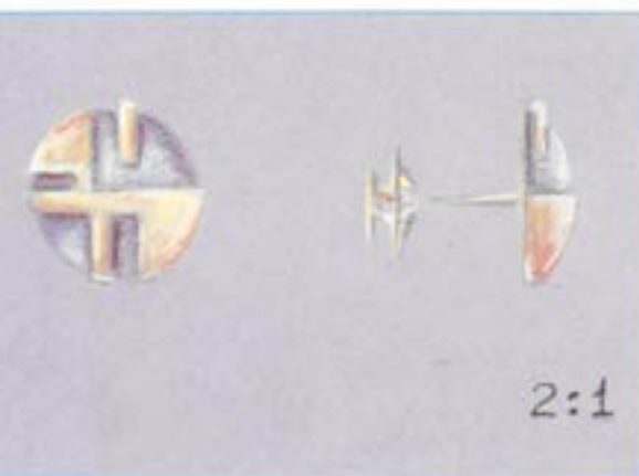
Εικ. 6.5 Σχέδιο καρφίτσας τύπου “μπουτόν”, σε χρυσό και ασήμι. Κάτοψη και πλάγια όψη, σε κλίμακα 2:1.
