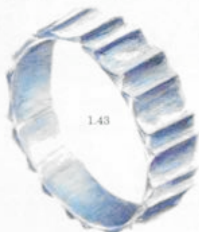
Εικ. 1.43 Αξονομετρικό σχέδιο βραχιολιού υπό κλίση 30^\circ/30^\circ .
